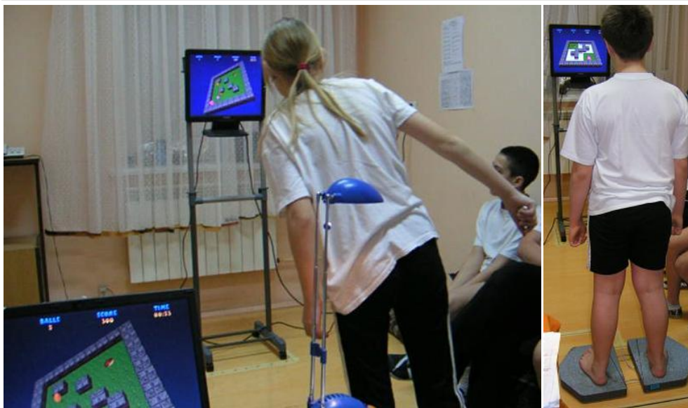
Ryc. 4. Dzieci stojące na dwuplatformowej wadze tensometrycznej i grające w grę komputerową sterowaną ruchami ich ciała (dzięki przemieszczaniu się COP_{LL} i COP_{LR} )
